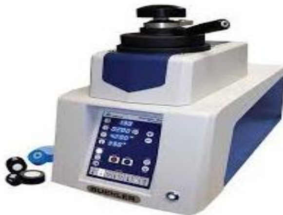
Figure IV.1. : Machine d'enrobage à chaud
