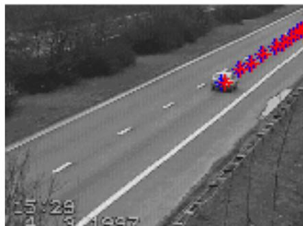
Figure IV.22. Trajectoire mesurée/estimée de l'objet en mouvement.
