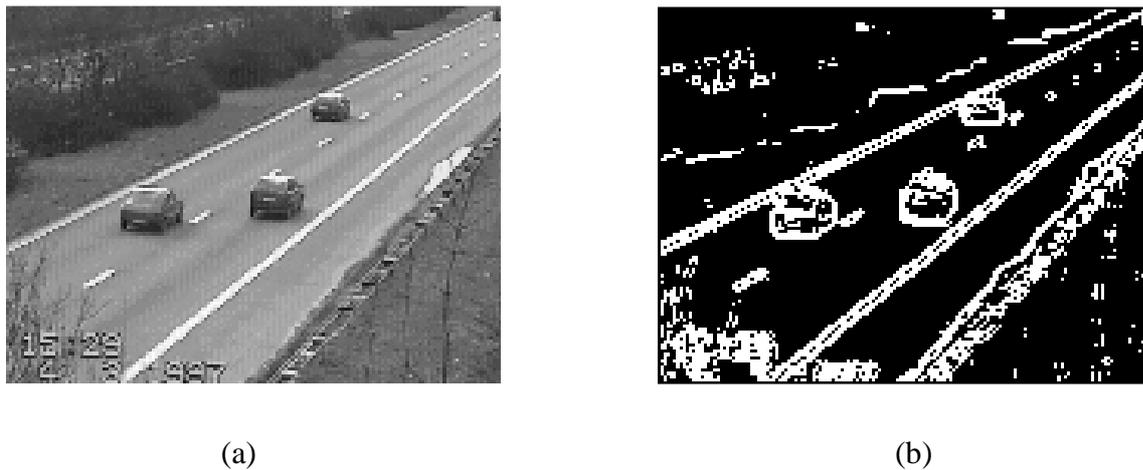
Figure I.5 exemple d'application du filtre Sobel, (a) : image d'origine, (b) : contour de Sobel.
