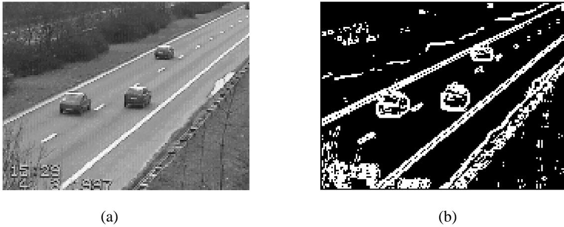
Figure I.4 Exemple d'application du filtre Robert, (a) : image d'origine, (b) : contour de Robert
