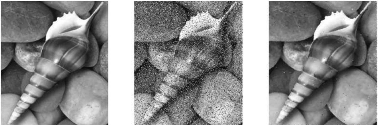
Figure I.2 application du filtre median, (a) : image d'origine, (b) : image bruitée (poivre et sel), (c) : filtre 3×3.
