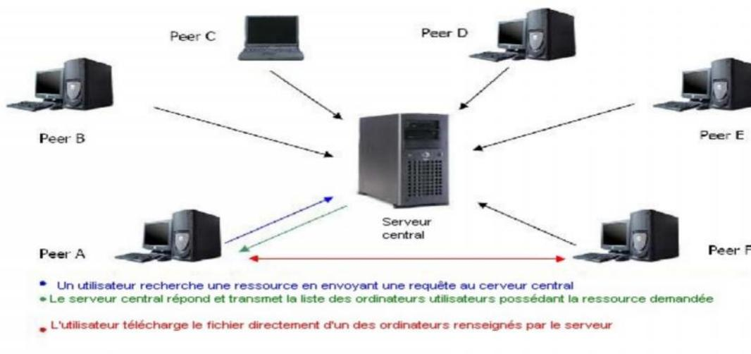
Figure 1.4 : L'architecture centralisée
