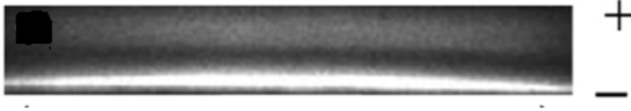
Figure I-14 : Photographie de l'espace inter-électrodes au maximum du courant d'une décharge lumineuse d'hélium (temps de pause 10 ns) [Ma 98].
