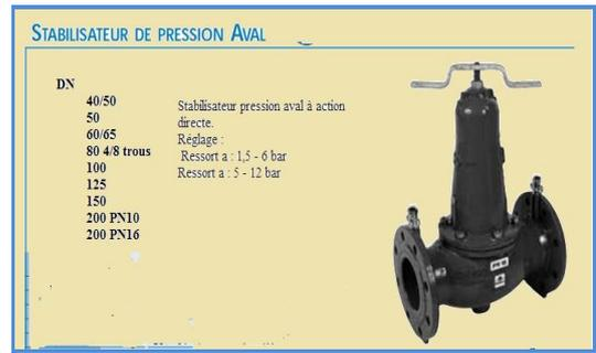
Figure 4.3 Modèle du stabilisateur
