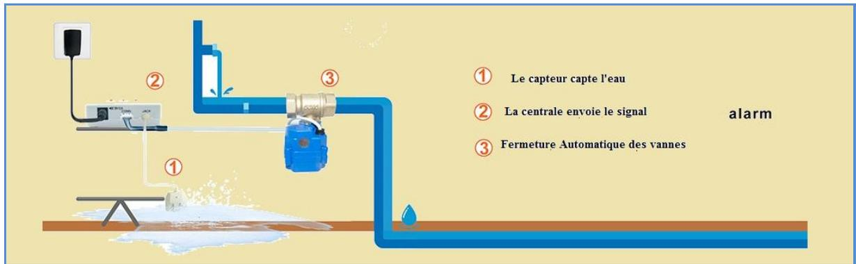
Figure. 3.8 Exemple d'une installation d'une vanne obturateur au niveau d'une conduite
