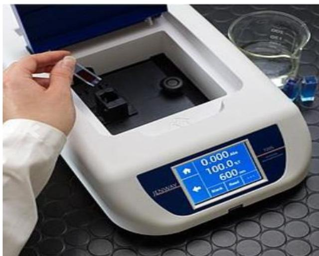
**Fig .14:** Photographie d'un spectrophotomètre
