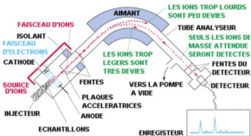
Figure II.27 : Appareil d'un spectromètre de masse
