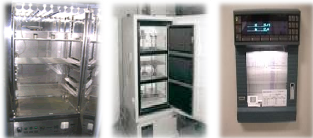
Figure I.5 : Equipements des études de stabilité
