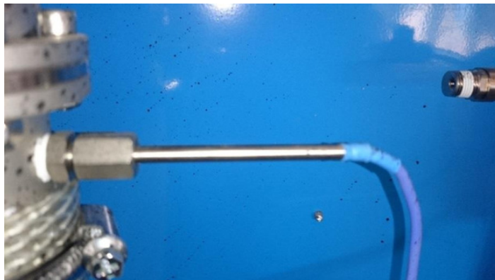
Fig.2-9 : Capteur de température type "J" [4]
