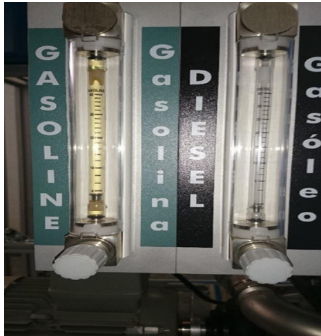
Fig.2-10 : Débitmètres de carburant (Essence et diesel) [4]
