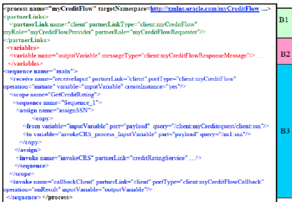
FIGURE VI.4. – La structure d'une spécification BPEL
