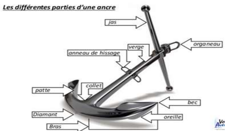
Figure III.10: Schéma descriptif de l'ancre
