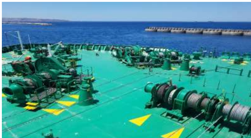
Figure IV.17 : plage de manœuvre
