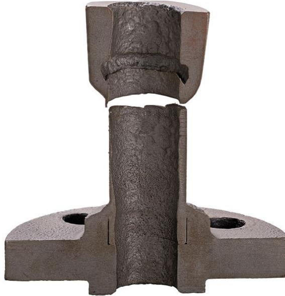
Figure 4 : Exemple de corrosion sulfurée à haute température.
