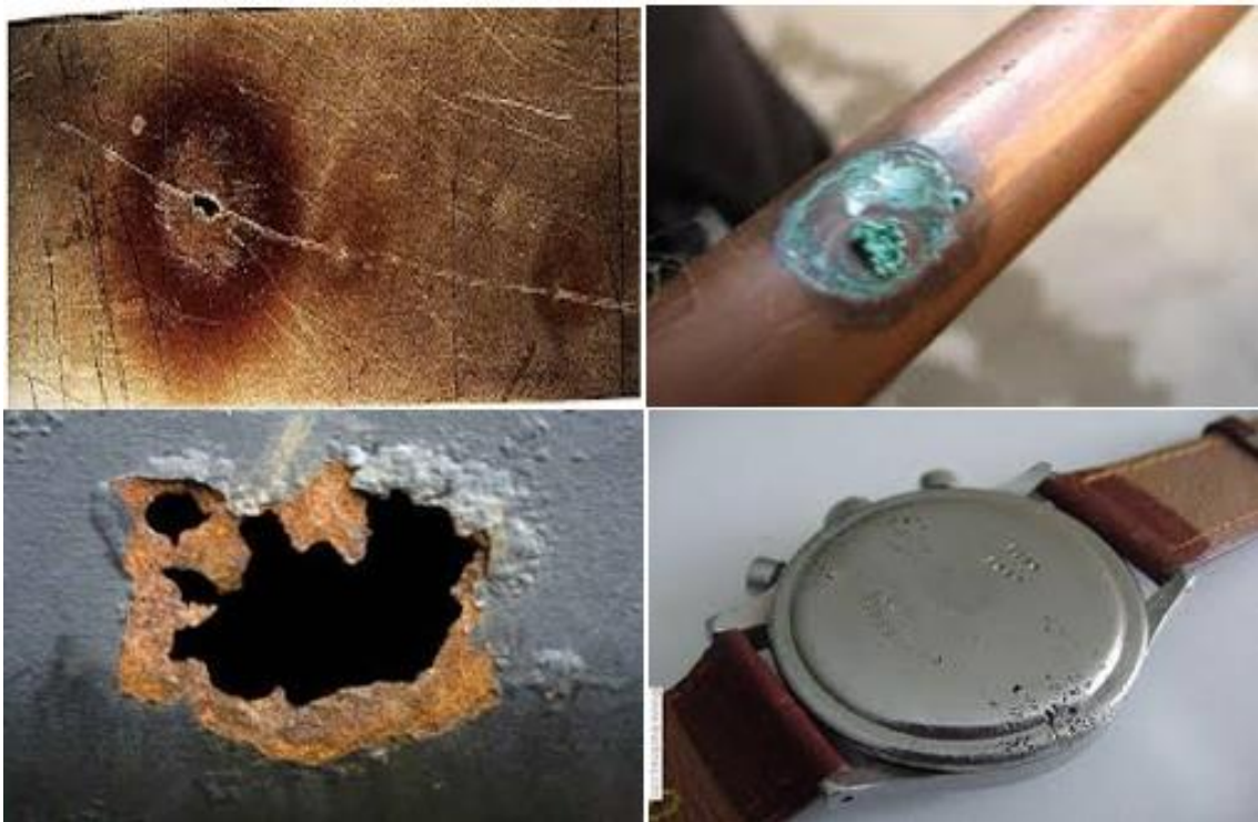
Figure 9 : Quelques exemples de corrosion par piqûres.
