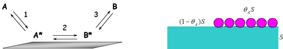
Figure V. 4 : Adsorption d'un composé gazeux A sur la surface d'un catalyseur.
