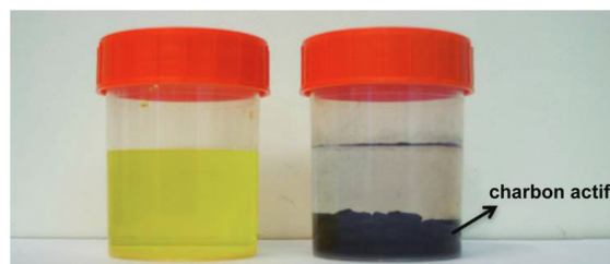
Figure 1: Solution de colorant élémentaire jaune, avant (gauche) et après (traitement à l'aide de granules de charbon actif, via leur introduction directe dans la solution
