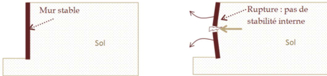
Figure 38. Stabilité interne d'un mur de soutènement.
