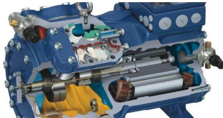
Figure 17 – Vue d'un compresseur semi-hermétique [04]
