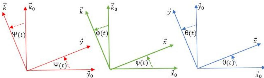
Dans le cas générale si le mouvement de rotation du repère  $(R)$  par rapport au repère  $(R_0)$  est constitué de plusieurs rotations élémentaires d'angle  $\theta_i$  appelé les angles d'Euler autour les axes  $(\vec{e}_i)$ . Alors:
