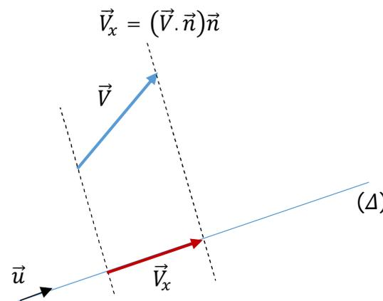
Figure 1.5 Projection orthogonale d'un vecteur sur un axe
