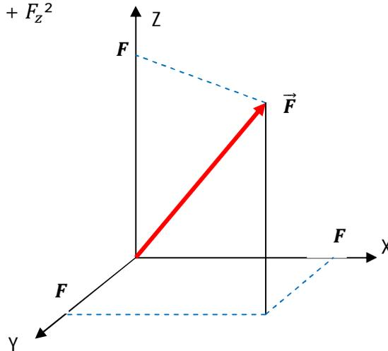
**Figure 2.6 Décomposition géométrique d'une force**
