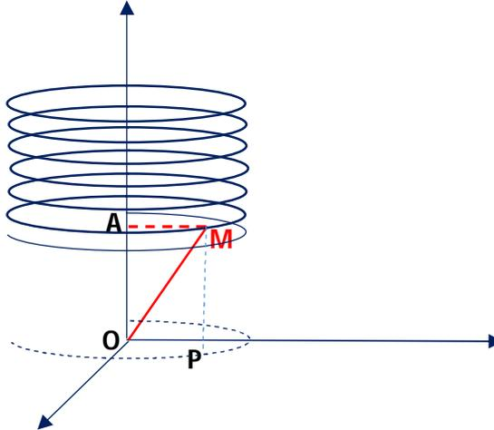
Le point  $P$  est la projection du point  $M$  sur le plan  $(O, \vec{i}_0, \vec{j}_0)$  il décrit une trajectoire circulaire dans ce plan.
