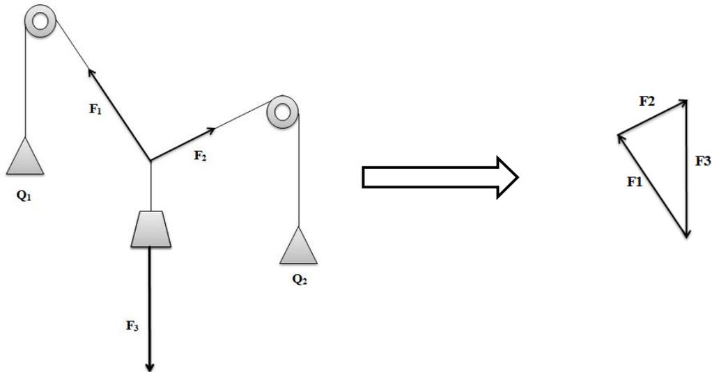
Figure 1.2 Système des forces en équilibre
