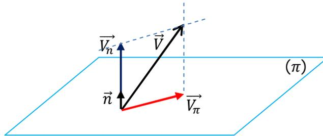
Figure 1.6 Projection orthogonale d'un vecteur sur un plan
