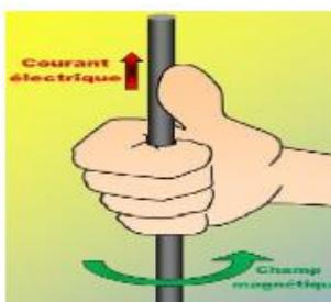
*Si le courant est orienté pour sortir du pouce, le vecteur champ magnétique est dirigé de la paume de la main vers le bout des doigts.*
