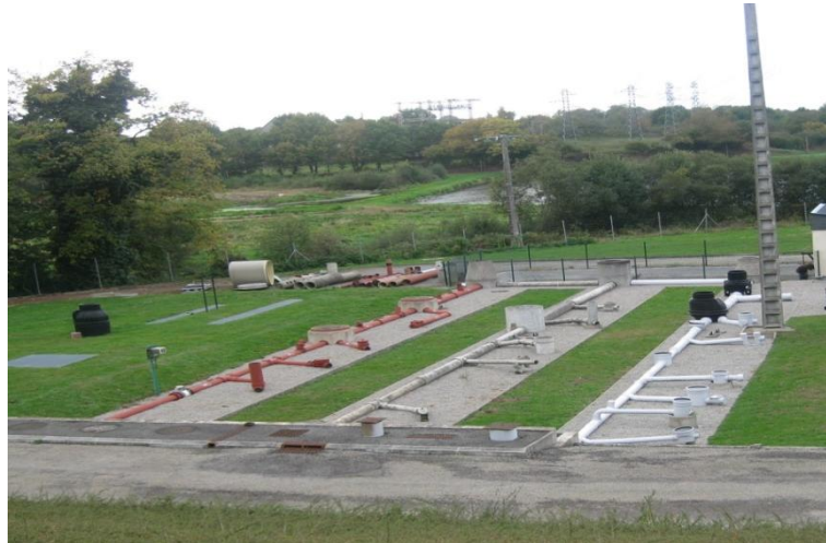
Figure 1. 1. Modèle réduit d'un réseau d'assainissement (photo prise par l'auteur en 2011 à la Souterraine – Office internationale de l'eau – Limoges)
