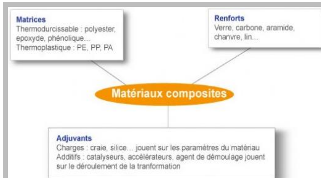
Fig. I.1 constitution d'un matériau composite.
