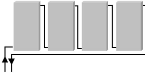
**Figure II.3 :** Raccordement en série [7].
