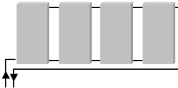
**Figure II.4 :** Raccordement en parallèle [7].
