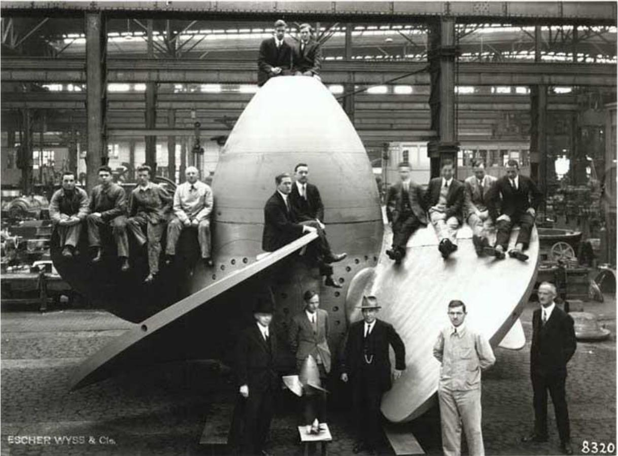
Figure 5.7 : Roue de Turbine Kaplan
