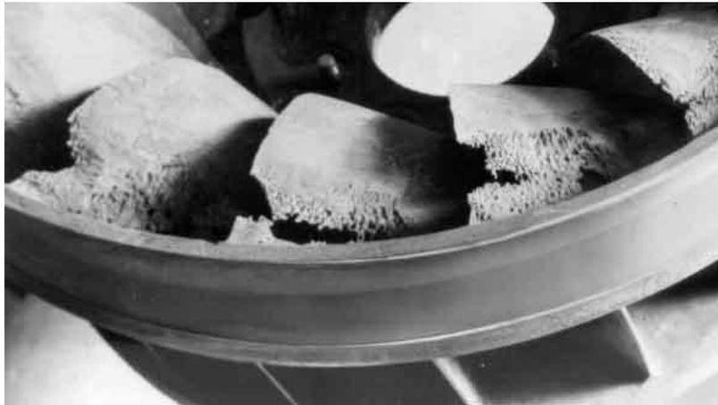
Figure 4.1 : Dégâts par cavitation
