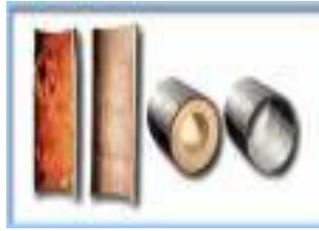
Figure I.25: Entartrage de tuyauterie.
