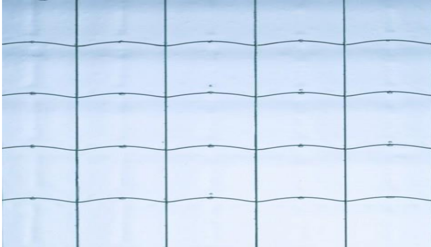
Figure II.5 : Illustration du verre armé [11].
