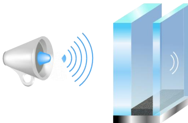
Figure II.16 : Principe du double vitrage dissymétrique [22].
