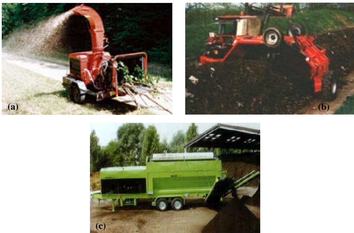
Figure 41 : (a) Broyeur, (b) Retourneur d'andain, (c) Crible (trommel rotatif, tamis à disques, tamis vibrants)
