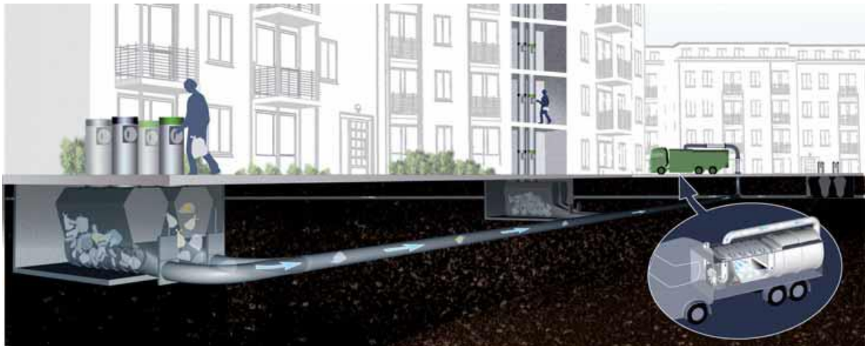
Figure 16 : Schéma de principe de la collecte pneumatique des ordures ménagères.
