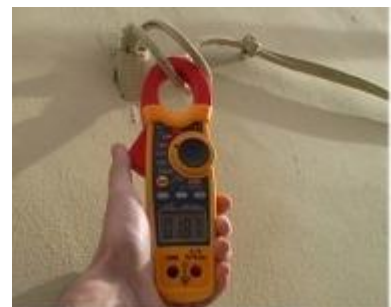
Pince ampèremétrique vérifiant le courant consommé durant un raccord.
