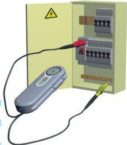
Mesure de l'isolement entre phase et PE
