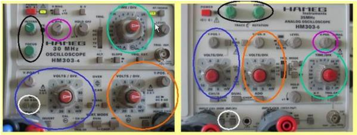
Les boutons entourés de cercles de même couleur correspondent à la même fonction pour ces deux oscilloscopes.
