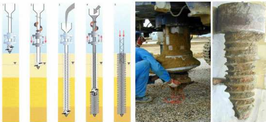
Figure 2-6 : Pieu vissé à pointe perdue Atlas [21]
