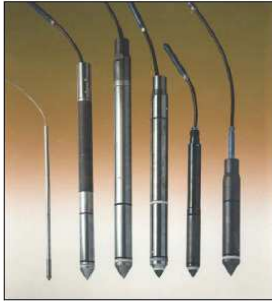
Figure III-3 : Photographie de cônes CPT (Doc. GEOMIL)
