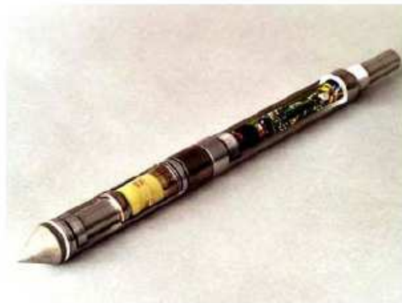
Figure III-2 : Schéma de principe et photographie d'un piézocône (Doc. GEOMIL)
