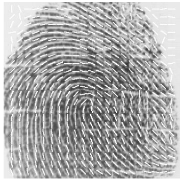
Figure III.18 : Le champ d'orientation d'une image d'empreinte digitale
