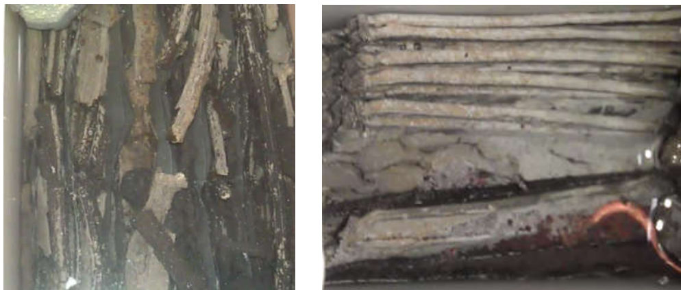
FIGURE V-19 : Court-circuit entre les grilles métalliques d'une chambre d'une batterie acide-au-plomb sur l'image de la gauche et sulfatation complète des grilles sur l'image de la droite
