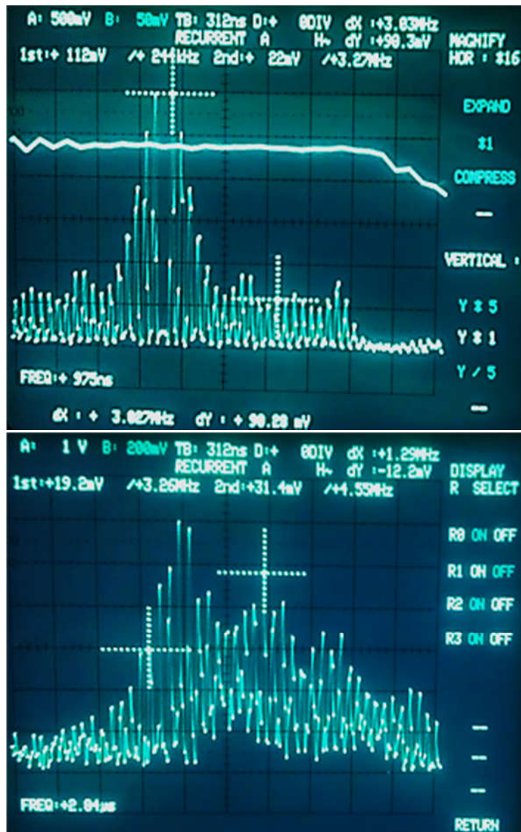
FIGURE V-13 : Amplitude du pic de 3.27 MHz lors de la désulfatation avec la fréquence 244 kHz
