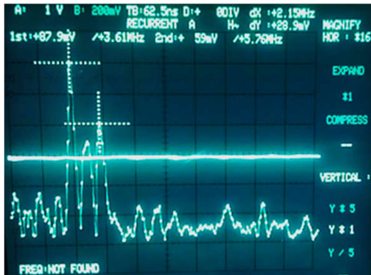
FIGURE V-16 : Agrandissement autour de la fréquence 3.61 MHz de l'analyse spectrale du courant de désulfatation à la fréquence de 106 kHz d'une batterie très sulfatée
