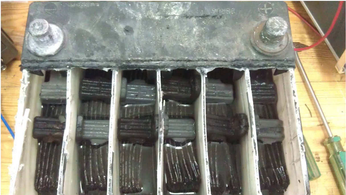
FIGURE V-18 : Ouverture d'une batterie supposée complètement sulfatée
