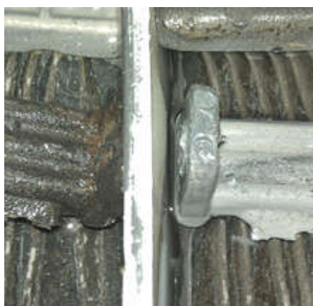
FIGURE V-20 : Cisaillement d'un rivet de liaison entre le (-) de la première chambre et le (+) de la seconde chambre
