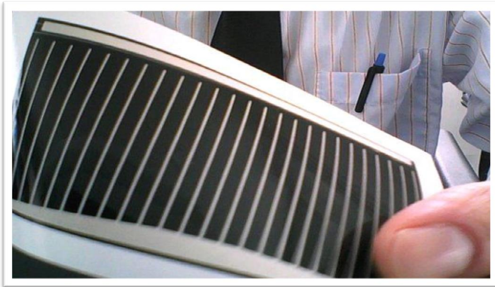
Figure I. 8 : Cellule en CIGS, efficacité de 8,5% (Source. Dantor).
