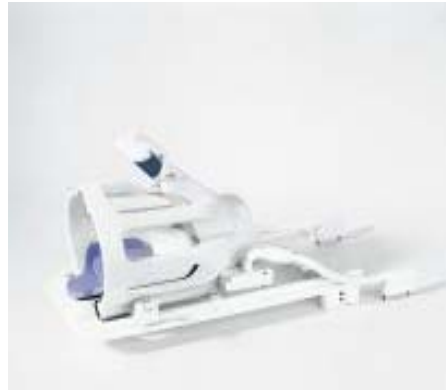
Fig. 1.11 : Antenne radiofréquence placée sur le patient lors d'une acquisition d'images de la tête.
