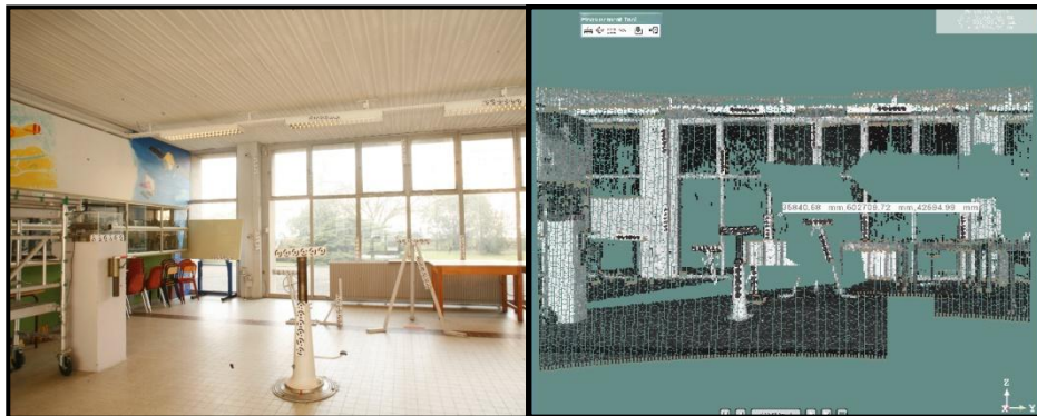
Figure 3.9 : Acquisition de la scène au trimble GX
