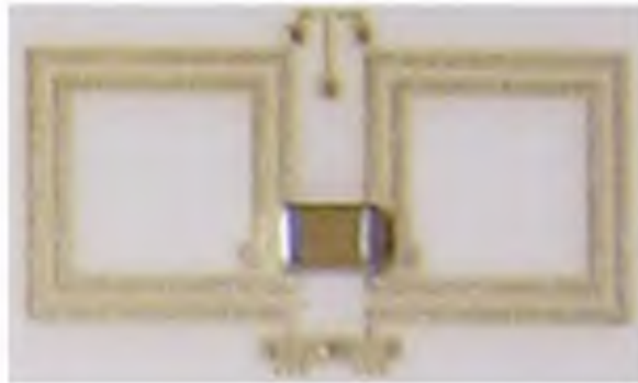
Figure I.27 : Microphotographie d'un micro-transformateur de forme carrée réalisé sur une surface de (0.8 x 1.3 cm 2 ) [Da-1]
