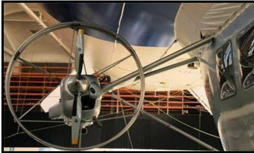
**Figure I.12.** Exemple d'un moteur à hélice de dirigeable
