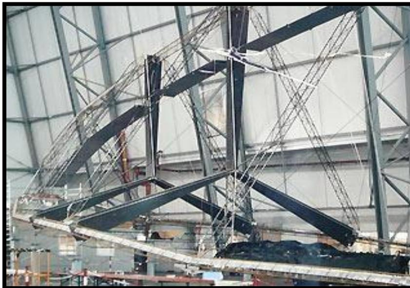
**Figure I.10.** Structure métallique d'un dirigeable semi-rigide (Zeppelin NT)
