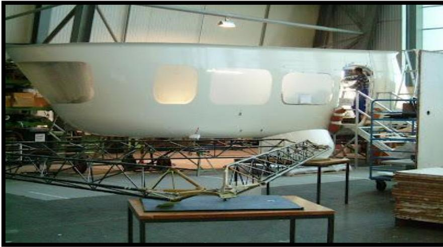
**Figure I.16.** Construction de la nacelle
