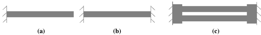
Figure 1.8 : Trois simples implémentations d'un capteur à résonance. (a) : une poutre suspendu, (b) : poutre maintenu-maintenu, (c) : double diapason fini.
