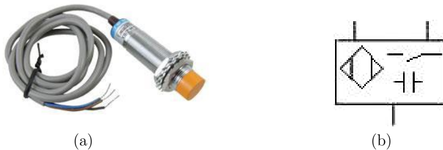
FIGURE 1: Capteur de proximité capacitif (a), et le symbole correspondant (b).
