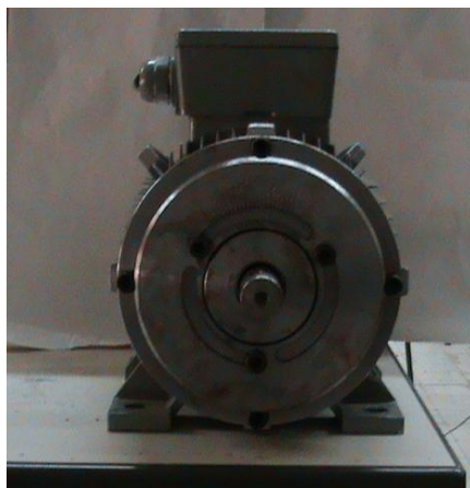
Figure 2.23 Montage du mécanisme d'excentricité sur le moteur du banc d'essai
