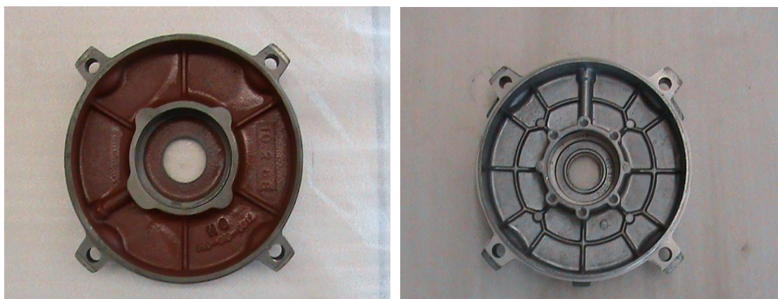
Figure 2.7 Flasque d'origine du moteur coté accouplement et opposé accouplement
