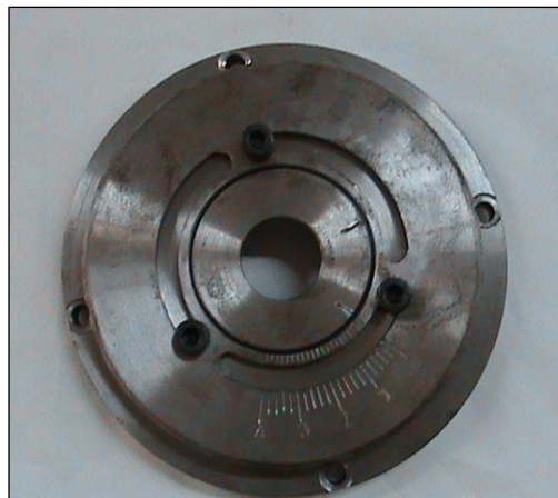
Figure 2.20 tracés des degrés de sévérités d'excentricité sur la pièce P2
