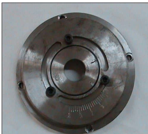
Figure 2.22 Serrage de la pièce P1 sur P2 par des vis en fente
