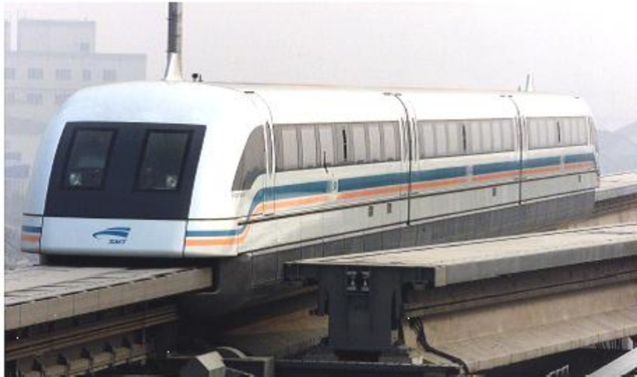
Fig. 03 : Train à lévitation magnétique et à moteur linéaire, inauguré le 31 décembre 2002, Le parcours de 30 km s'effectue actuellement en 8 minutes (vitesse moyenne = 225 km/h). La vitesse maximale d'exploitation a été fixée à 420 km/h.
