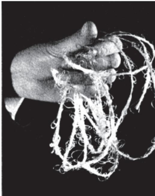
Fig. I. 7.stratifil bouclé.
