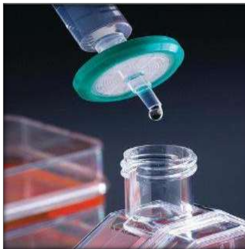
Figure 16 : Filtration sous pression
