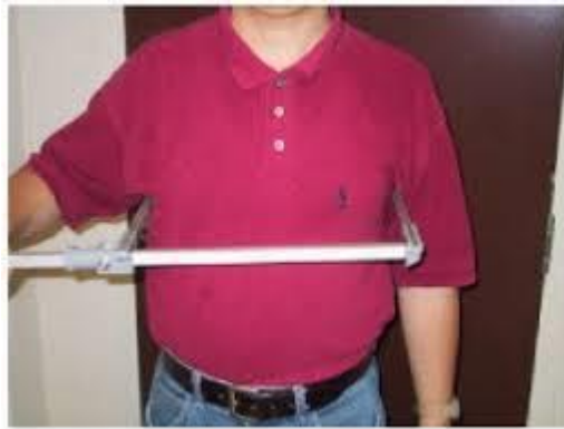
جهاز الانثروبوميتر لقياس أطوال اطراف جسم
