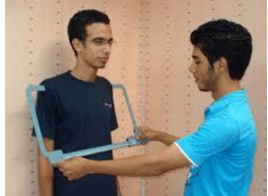
جهاز الانثروبوميتر لقياس أطوال اطراف جسم
