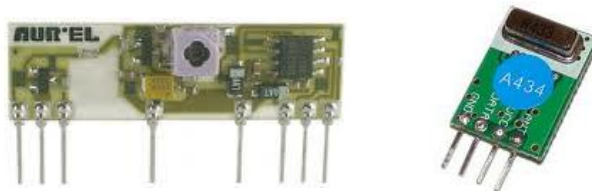
Figure 4.9 : Module radio Émetteur TX433/ Récepteur RF 433.
