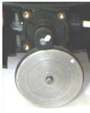
Figure 4.6 : Installation mécanique des codeurs optiques du robot ARP.
