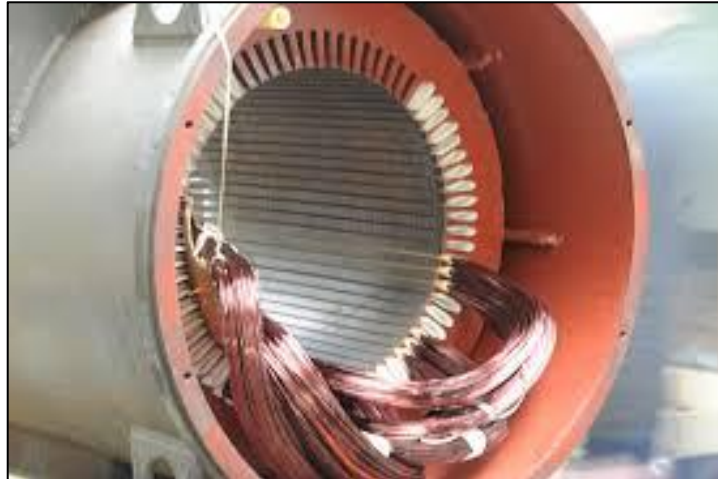
Figure I-4. Stator d'une machine à courant alternatif avec bobinage et isolation en Mica.
