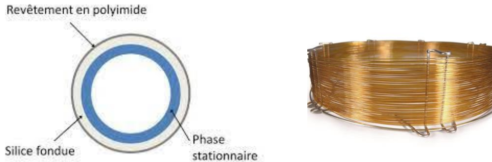
Figure 38 : Schéma (en coupe) et photo d'une colonne capillaire
