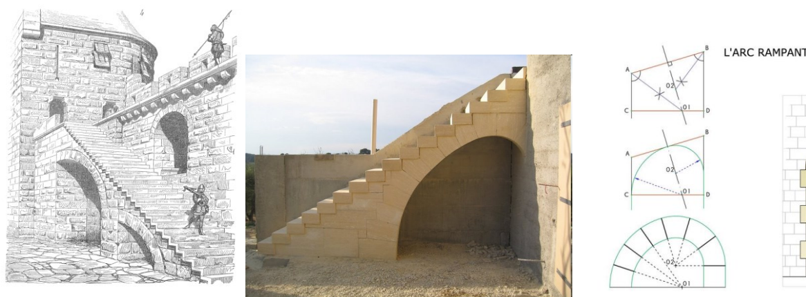
Figure 107 : la mise en œuvre d'un escalier sur arc rampant. Réf. : (Viollet-Le-Duc, 1868), Internet.
