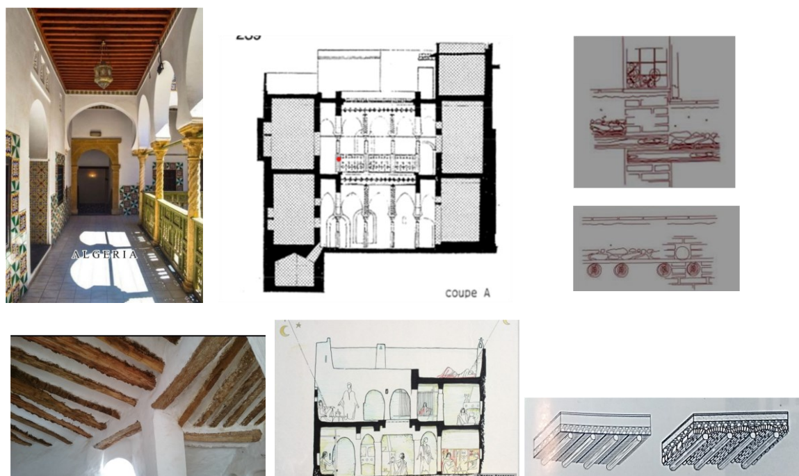
Figure 106 : Les espaces structurés par les poutrelles apparentes dans les maisons de la casbah d'Alger et du Mzab. Réf. : Internet et L. Kara Mostefa.
