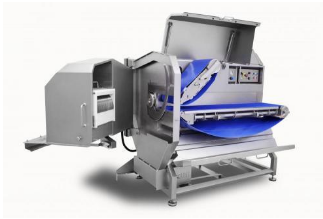
Figure 46 : Cubeuse/ Trancheuse en continu 1, 2 ou 3D pour produits frais ou raidis (Découpe Bi-Dimensionnelle)
