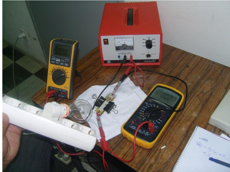
Figure III.23 : montage de caractérisation de la cellule solaire.
