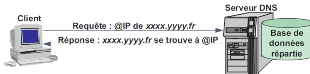
Figure V.6. Principe de la résolution de nom. [7]
