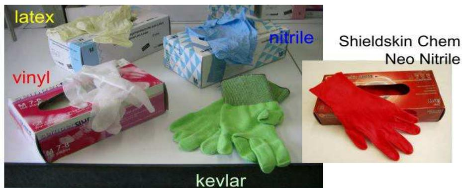
**Fig. 3.** Les différents modèles de gants de protection (**Shematek & Wood, 2012**).
