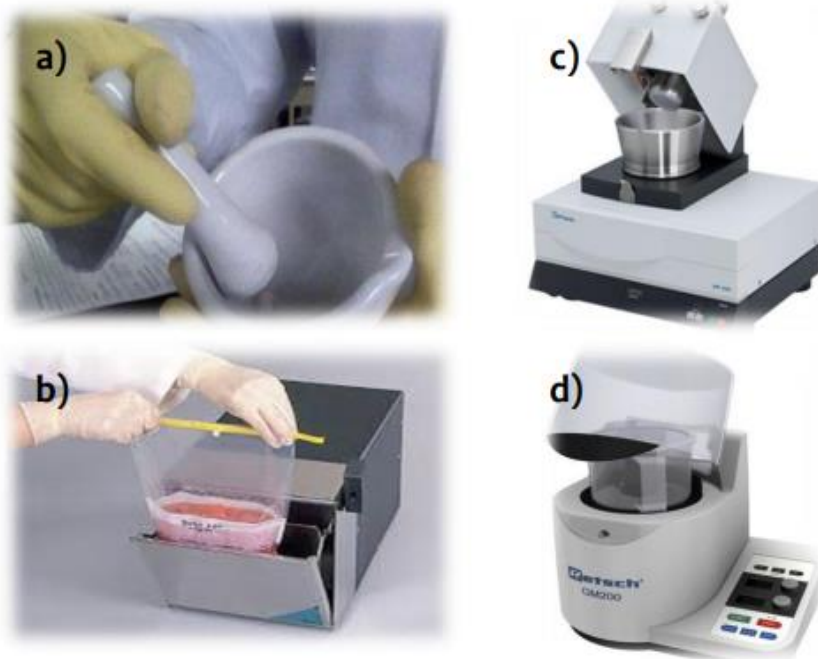
Figure 4 : Les broyeurs de laboratoire : (a) Broyeur à main (mortier et pilon), (b) broyeur électrique à pédale type stomacher, (c) broyeur électrique type mortier et pilon, (d) broyeur électrique type à couteaux.
