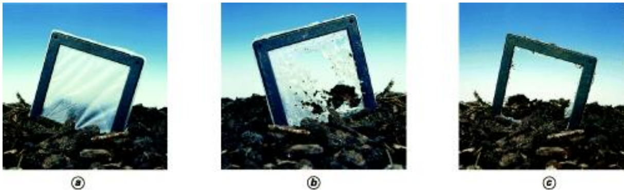
Figure III.5. Test illustrant la dégradation en compost d'un film d' Ecoflex ®. Moins de 4 semaines à 55 °C
