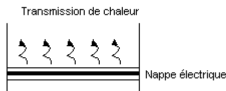
Figure III.1 Schéma de diffusion de chaleur d'une nappe électrique (Plancher chauffant)
